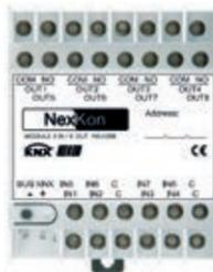
Il modulo NK-1088, munito di opportuna interfaccia KNX, è fornito di 8 ingressi per contatti puliti atti ad interfacciare sensori, pulsanti tradizionali, ecc, configurabili, tramite SW ETS, anche come 8 canali di uscita a bassa tensione per il pilotaggio di LED di segnalazione per la visualizzazione di stati su pulsantiere o pannelli sinottici adibiti al monitoraggio dell'impianto.
