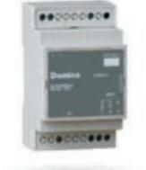
Il modulo DFDMX consente di gestire, attraverso il bus Domino, fino ad un massimo di 32 dispositivi DMX. Il modulo consente la comunicazione sui primi 64 canali dei 512 previsti dal protocollo DMX. Il modulo DFDMX trova applicazione nel campo dell'illuminazione professionale e domestica che impiega sistemi e apparecchiature che comunicano mediante il protocollo USITT DMX-512. Il modulo DFDMX offre le seguenti caratteristiche:
