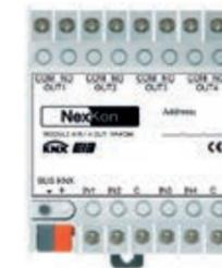
Il modulo NK-1044, munito di opportuna interfaccia KNX, è fornito di 4 ingressi per contatti puliti atti ad interfacciare sensori, pulsanti tradizionali, ecc, configurabili, tramite SW ETS, anche come 4 canali di uscita a bassa tensione per il pilotaggio di LED di segnalazione per la visualizzazione di stati su pulsantiere o pannelli sinottici adibiti al monitoraggio dell'impianto.
