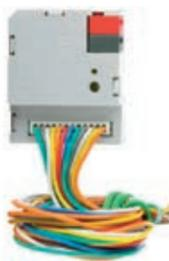
NK-IO44M, è dotato di 4 ingressi dedicati all'interfacciamento di contatti puliti, ad esempio sensori, pulsanti tradizionali, ecc., e di 4 canali di uscita a bassa tensione per il pilotaggio di LED di segnalazione per la visualizzazione di stati su pulsantieri o pannelli sinottici adibiti al monitoraggio dell'impianto. Configurazione via ETS.
