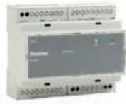
Il modulo alimentatore DFPW2 genera la tensione necessaria al funzionamento dei moduli collegati al bus Domino. La tensione di ingresso per il corretto funzionamento del modulo DFPW2 deve essere 230Vca 50Hz.
