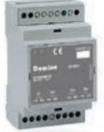
Il modulo DF4DV consente il controllo, attraverso il bus Domino, di 4 dispositivi con ingresso 0÷10V, tipicamente dimmer o ballast elettronici esterni, ma anche valvole modulanti o simili. Il modulo DF4DV può essere controllato da pulsanti connessi a moduli di ingresso o da supervisore o da videoterminale (es. touch screen).
